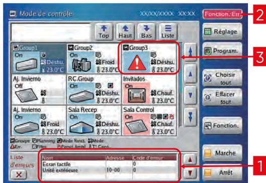
1. Quand une erreur se produit, la fenêtre "Liste d'erreurs" s'ouvre en bas de l'écran "Mode contrôle". Le nom de l'unité, son adresse et le code erreur apparaissent.
